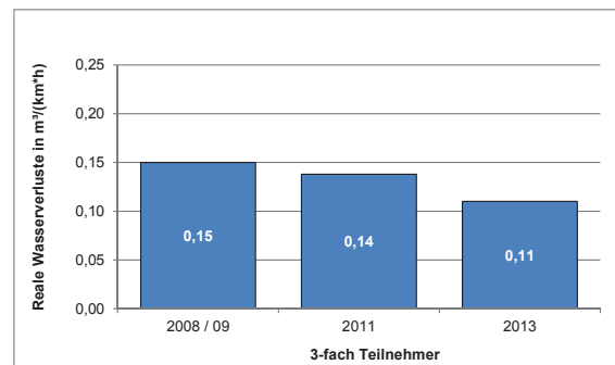
Abbildung 22: Entwicklung – reale Wasserverluste (Unternehmen mit dreifacher Teilnahme)
