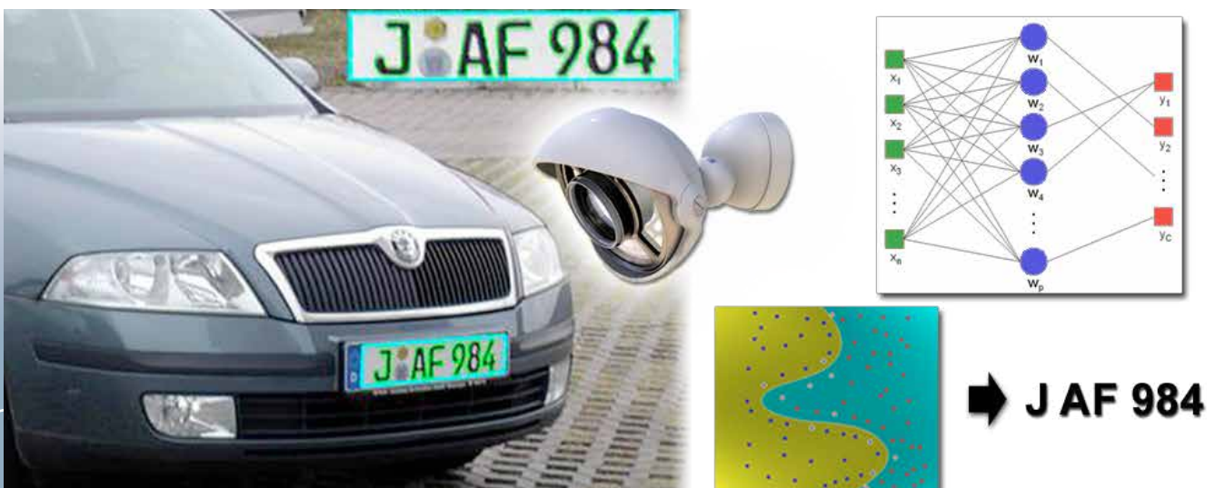
Kamera mit eingebetteter Intelligenz für die Kennzeichenerkennung
