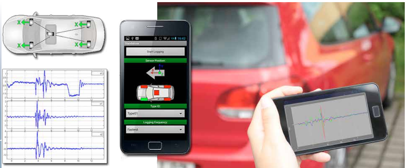
Mobiles Sensornetzwerk für die Beurteilung der Fahrzeugdynamik
