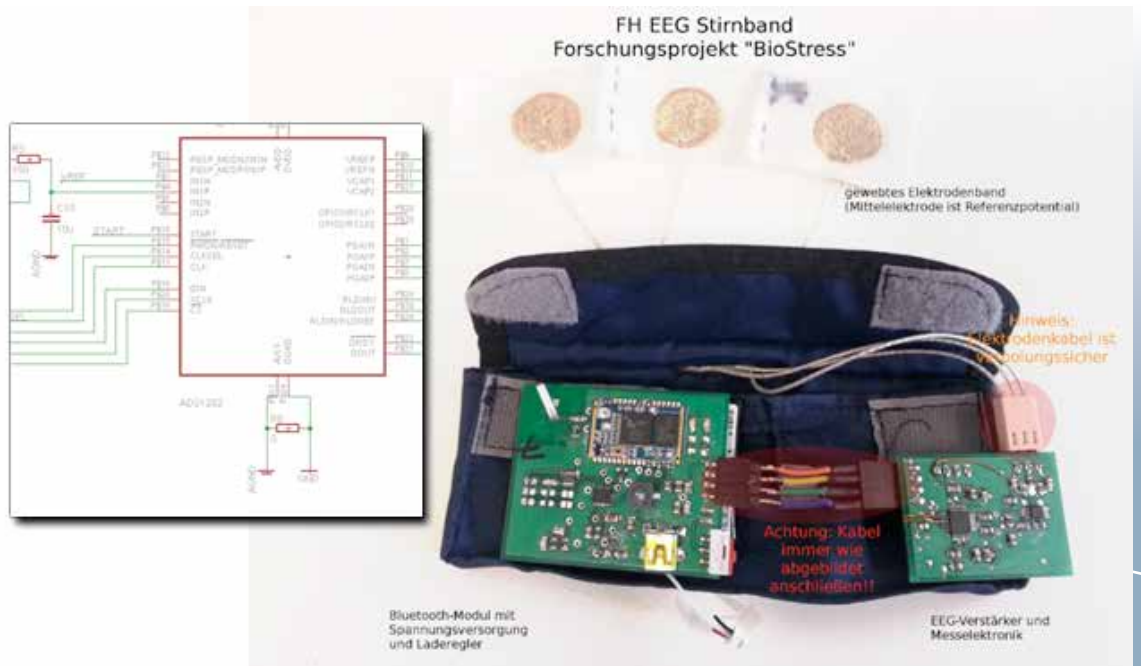
„BioStress“-System: eingebettete Module zur Biosignalerfassung und Analyse von Stress- und Beanspruchungsfaktoren
