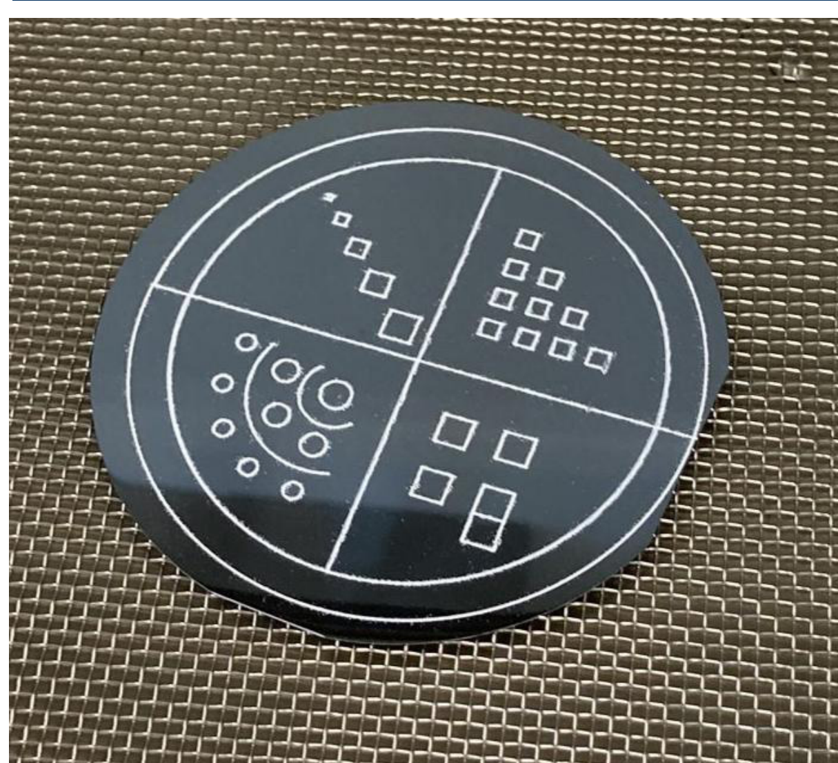
Glasrit auf Silizium-Wafer [Piezojetting]
