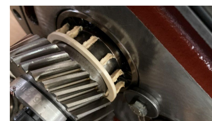
Fehlerzustand: Zerstörtes Antriebslager (Plastikförmig ausgetreten)
