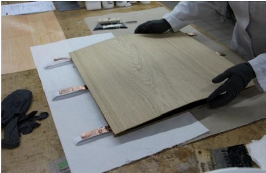
Abbildung 1: Elektrisch leitfähiger Demonstrator (Parkettelement) in Verbundbauweise
