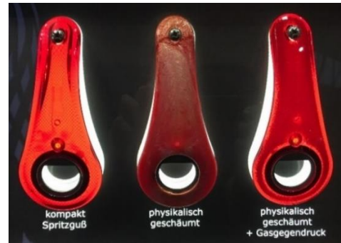
Vergleich der Oberflächen mit unterschiedlichen Schäumverfahren, Quelle: KIMW
