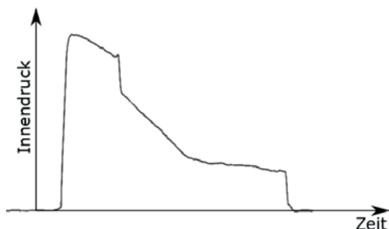
Abbildung 2: Reale Druckkurve, die während der Durchführung einer Versuchsreihe mit dem eingebetteten Diagnosesystem (EDS) aufgezeichnet wurde. Das produzierte Teil genügt nicht den Qualitätsanforderungen, da u.a. die Restkühlzeit zu niedrig eingestellt war. Die Einspritzphase ist in der Kurve nicht erkennbar, da der Sensor am Fließwegende positioniert ist.
