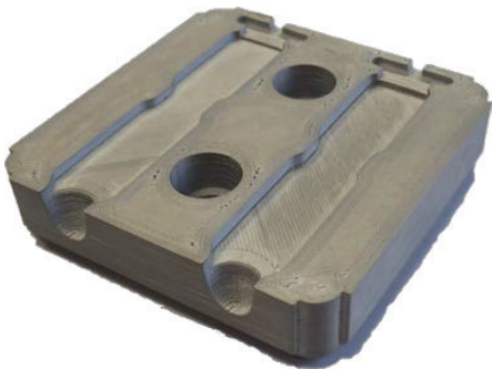
6: Additiv gefertigter Werkzeugeinsatz zur Endbearbeitung
