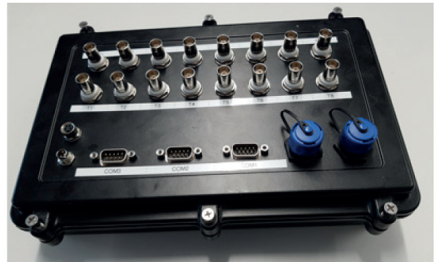
Abbildung 4: Eingebettetes Diagnosesystem mit vier piezoelektrischen Drucksensoreingängen (links) und mit acht piezoelektrischen Drucksensoreingängen (rechts). Beide Geräte stellen ihre Messdaten über eine integrierte USB-Schnittstelle bereit und sind mit der Software PowerMouldsView kompatibel.
