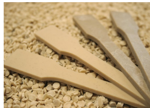
Cottonfaserverstärkte Kunststoffe Quelle: Fraunhofer IFAM
